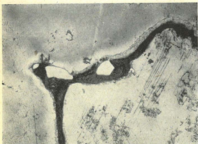
Obr. 15. Korečkový čep — makrostruktura — zjištěná přítomnost oxydických blan (300× zvětšeno)
