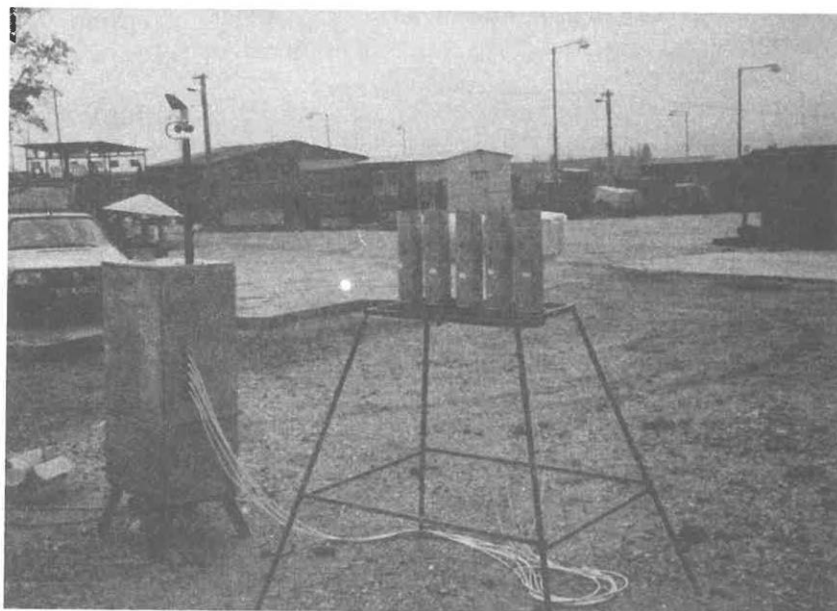
obr. 2 Elektronický systém pro měření koncentrace tuhého aerosolu v ovzduší a spadu
