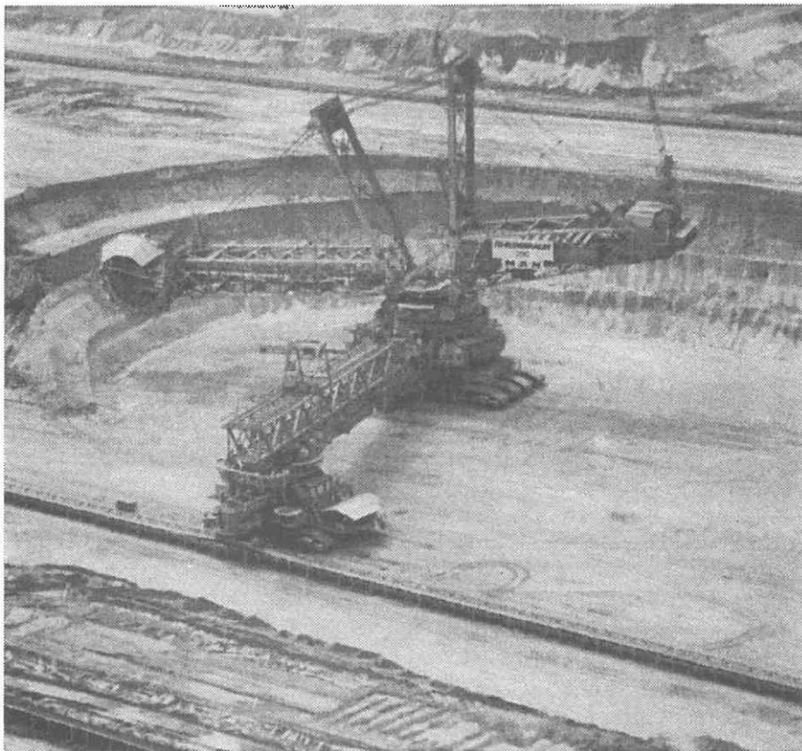
Dosud nejvýkonnější kolesové rýpadlo s kapacitou 240 000 m 3 rostlé zeminy za den, průměr kola 21,6 m.
