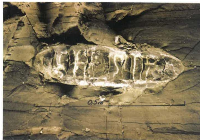
Obr. 20 Čočka pelokarbonátu se zřejmými krystaly ankeritu, uložená v cyprisových jílovcích II. skrývkového řezu
