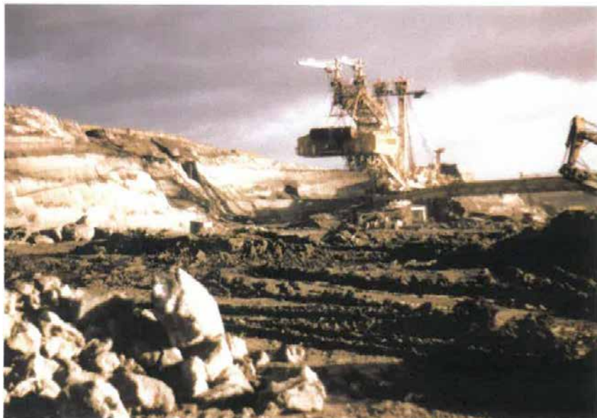
Obr. 12 Rýpadlo KU 800/1 v lomu Vršany dobývá horizont s pískovcovými pevnými polohami
