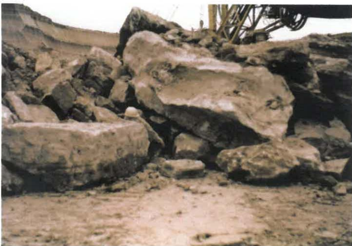
Obr. 6 Těleso pískovce rozvolněného trhačí prací
