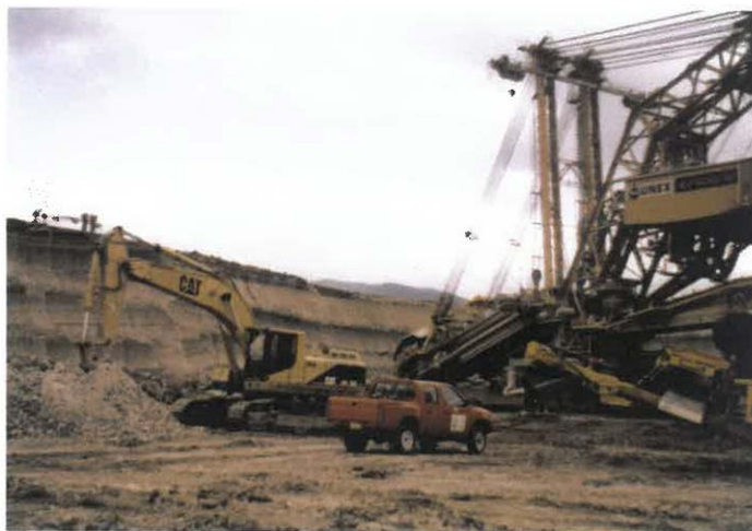
Obr. 7 Zpracování pevných poloh na pracovní pláni rýpadla KU 800/18, pomocí hydraulického kladiva a čelistového drtiče (vpravo)
