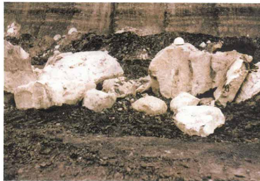
Obr. 13 Pískovcové pevné polohy na pracovní pláni ve II. řezu
