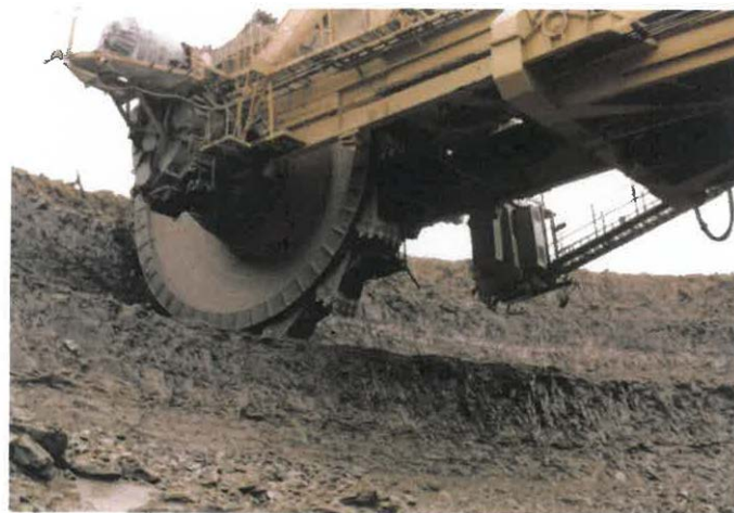
Obr. 21 Dobývání I. skrývkového řezu rýpadlem KU 800/16 v současnosti. Jsou zde dobře zřetelné linie karbonátových jílovců.
