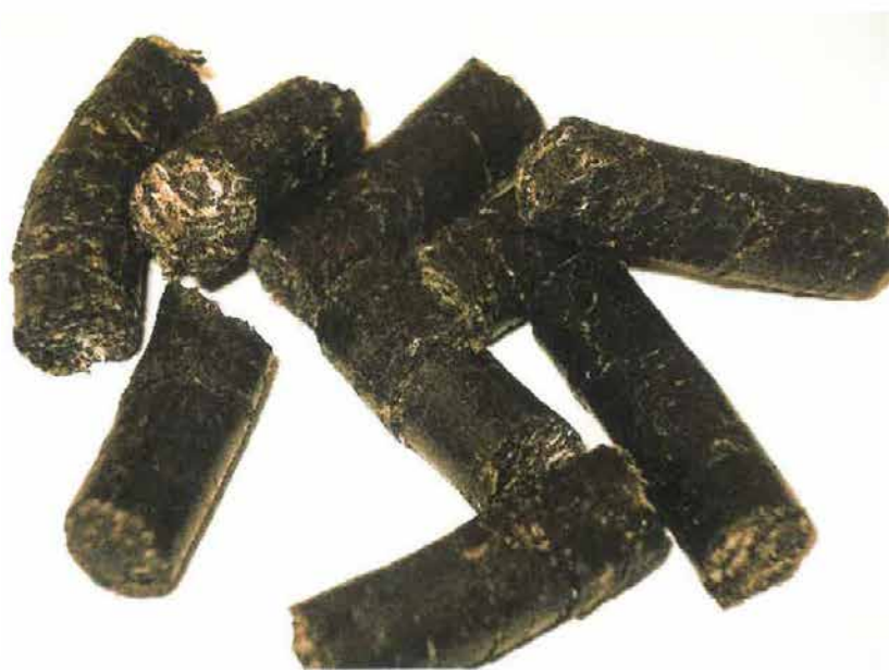
Obr. 4 Vzorek pelet vyrobených z uhlí a ASR
