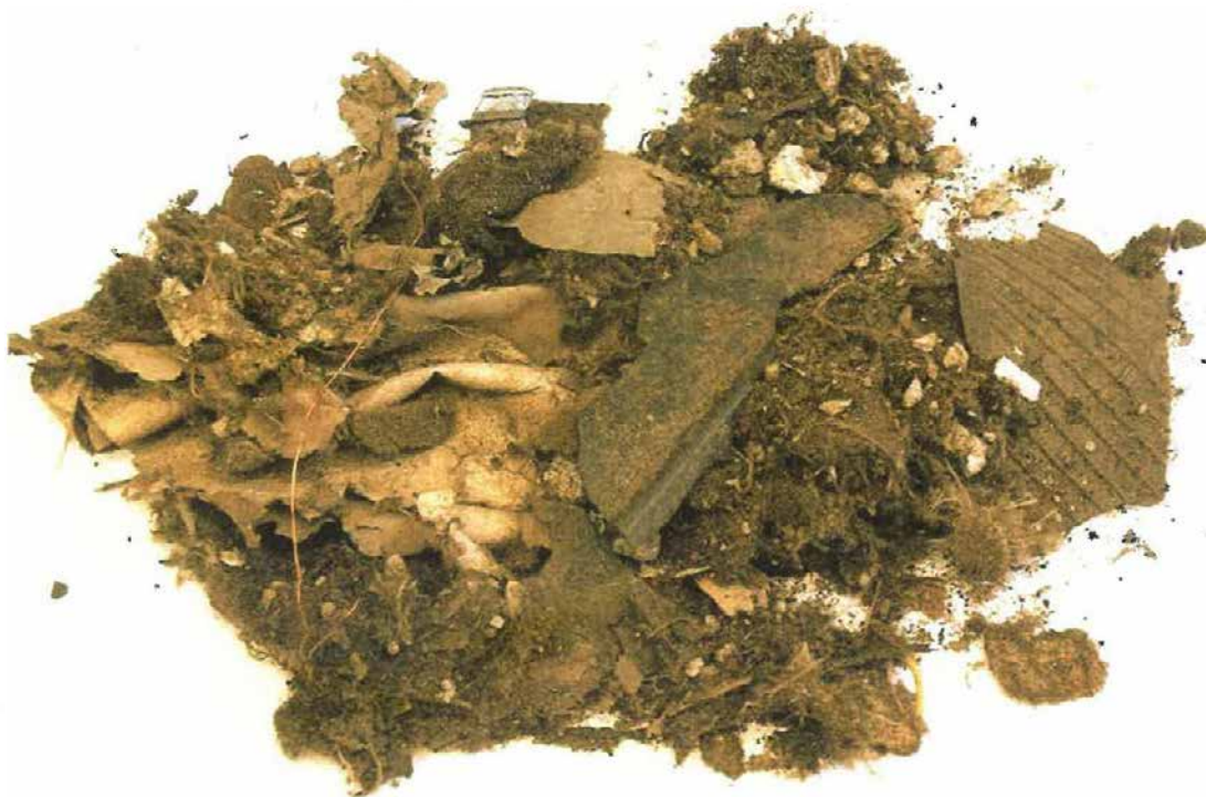
Obr.2 Vzorek ASR před vstupem do drtiče
