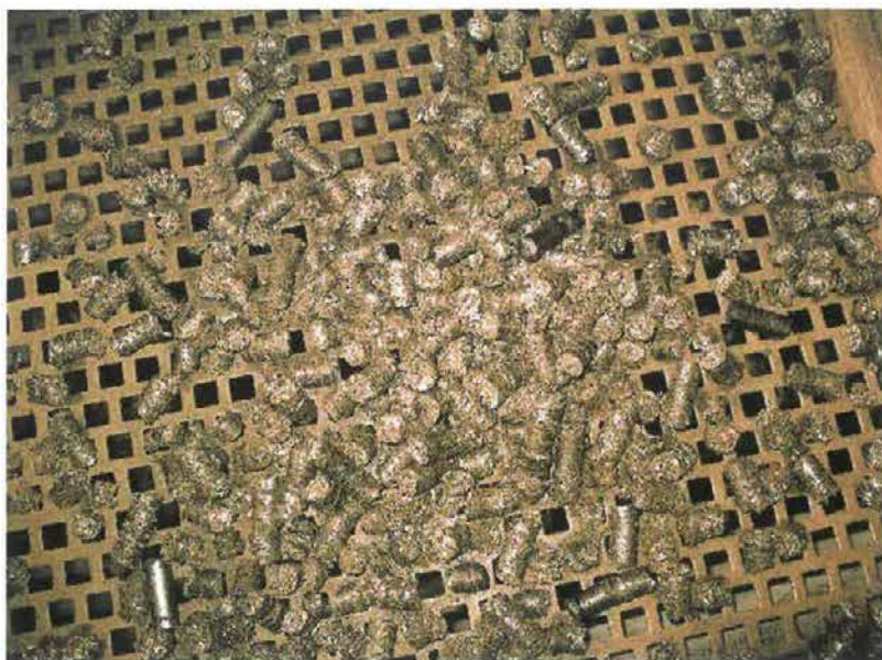
Obr. 3 Vzorek pelet vyrobených z uhlí a gumové pryže
