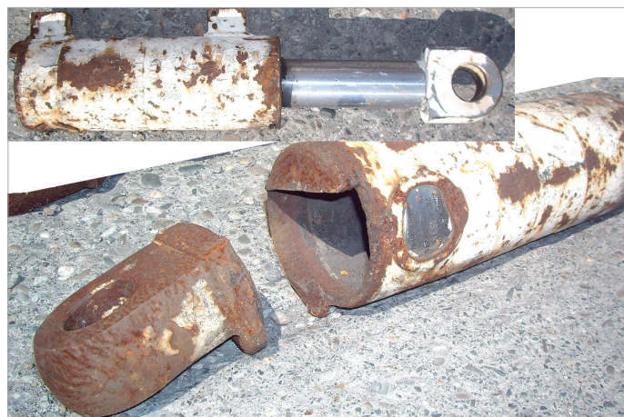
Obr. 6: Příklad válce z třetího typu poškození.
