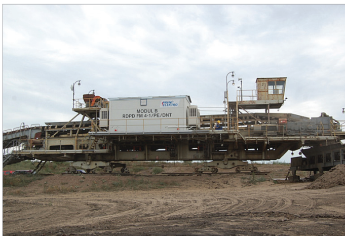
Obr. 1: Poháněcí stanice DPD a detail pohonu.
