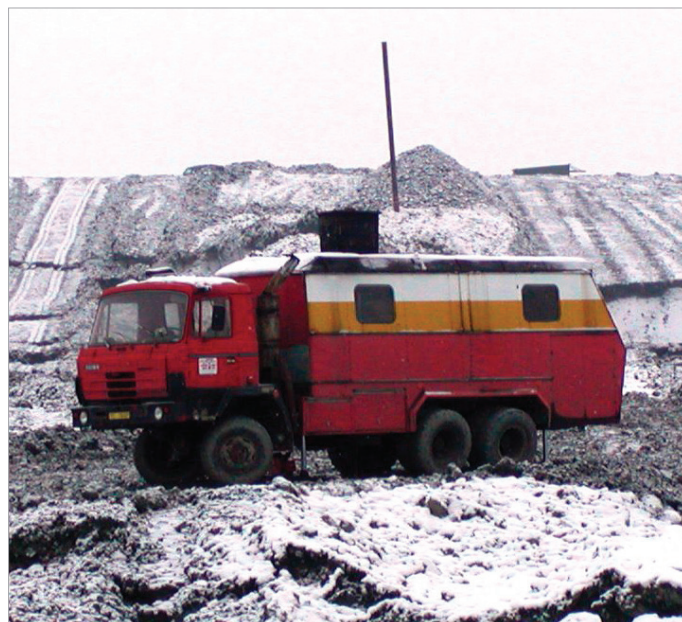
Obr. 1: Penetrační souprava umístěná na Tatře T815 v prostoru vnitřní výsypky Jiří.
