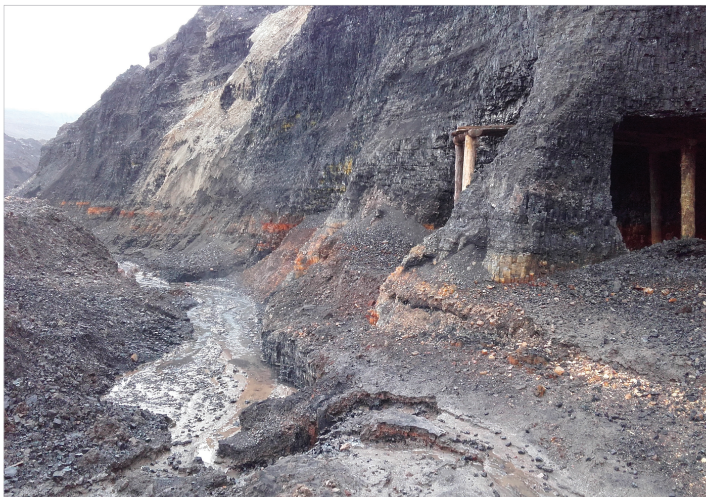
Obr. 5: Samovolný odtok vody ze stařinového systému v JZ části území.
