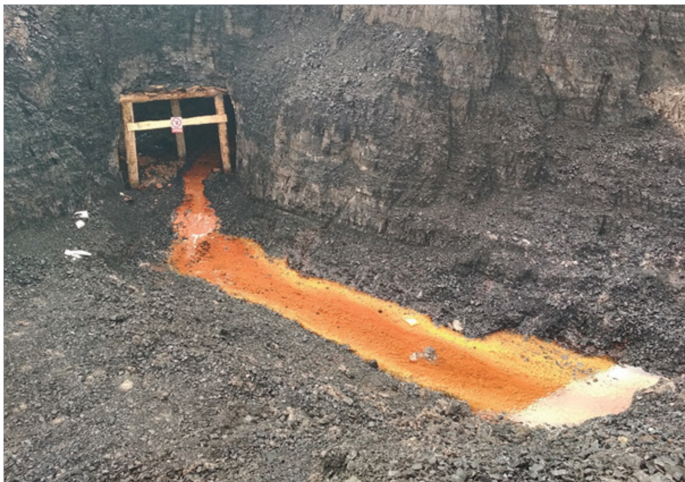
Obr. 4: Samovolný odtok vody ze stařinového systému.
