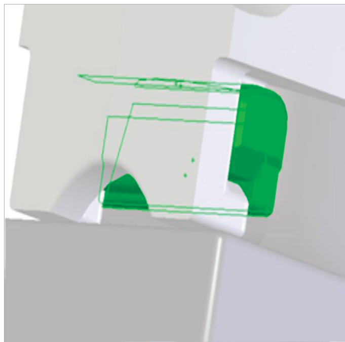
Obr. 4: Kontaktní plochy mezi korunkou a perem a mezi perem a adaptérem ESCO Super V39VYH.
