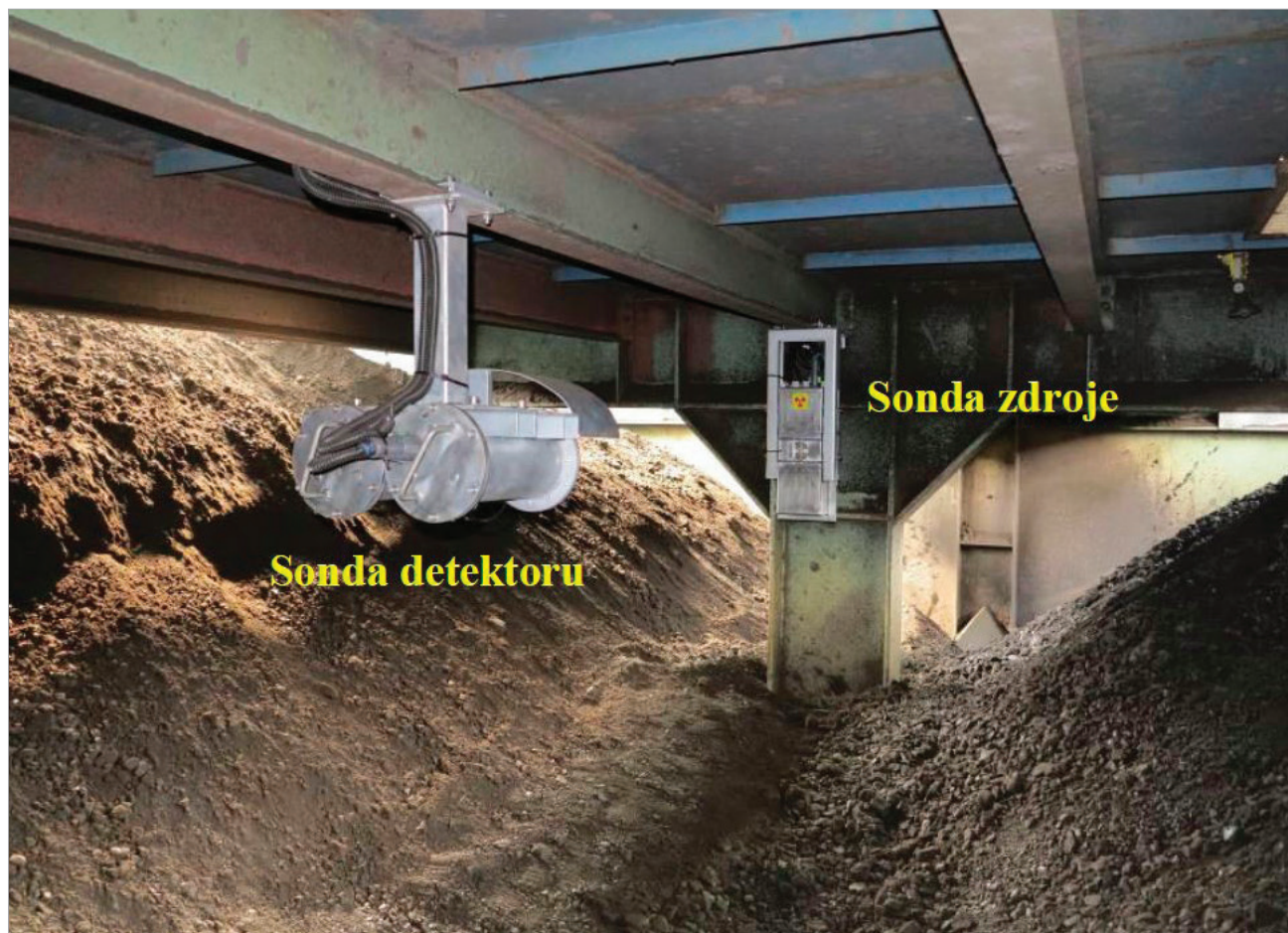
Obr. 2: Kontinuální měřič GM01-C v zásobníku uhlí.
