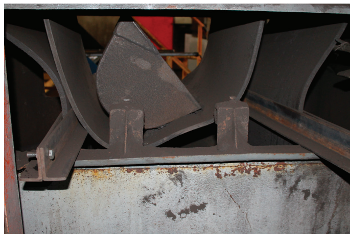
Obr. 3: Kurtový korečkový elevátor s uchycením korečku na pásu zápusťnými šrouby.
