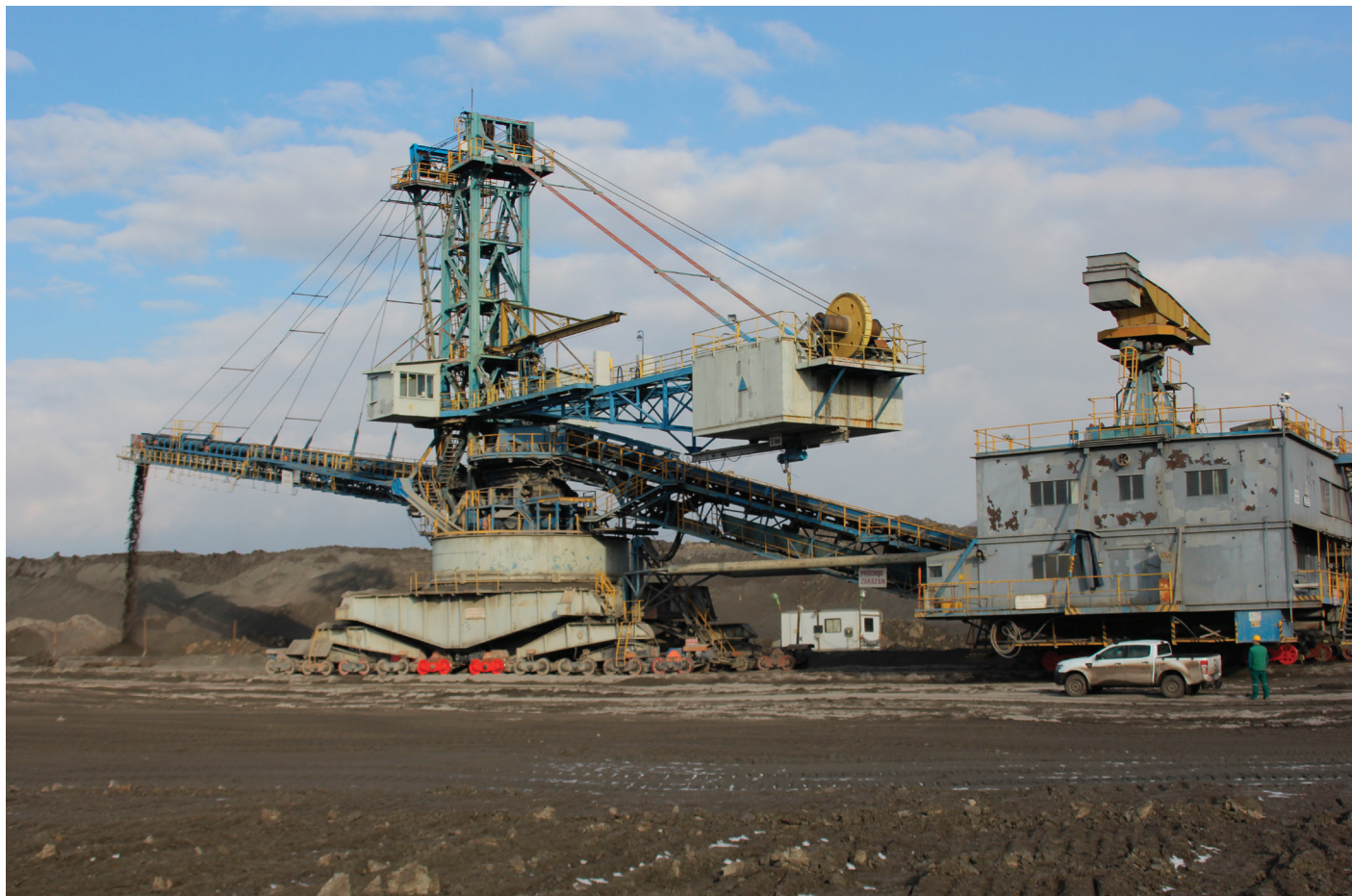
Obr. 2: Kolejový dvouvozový zakladač ZD 1800.
