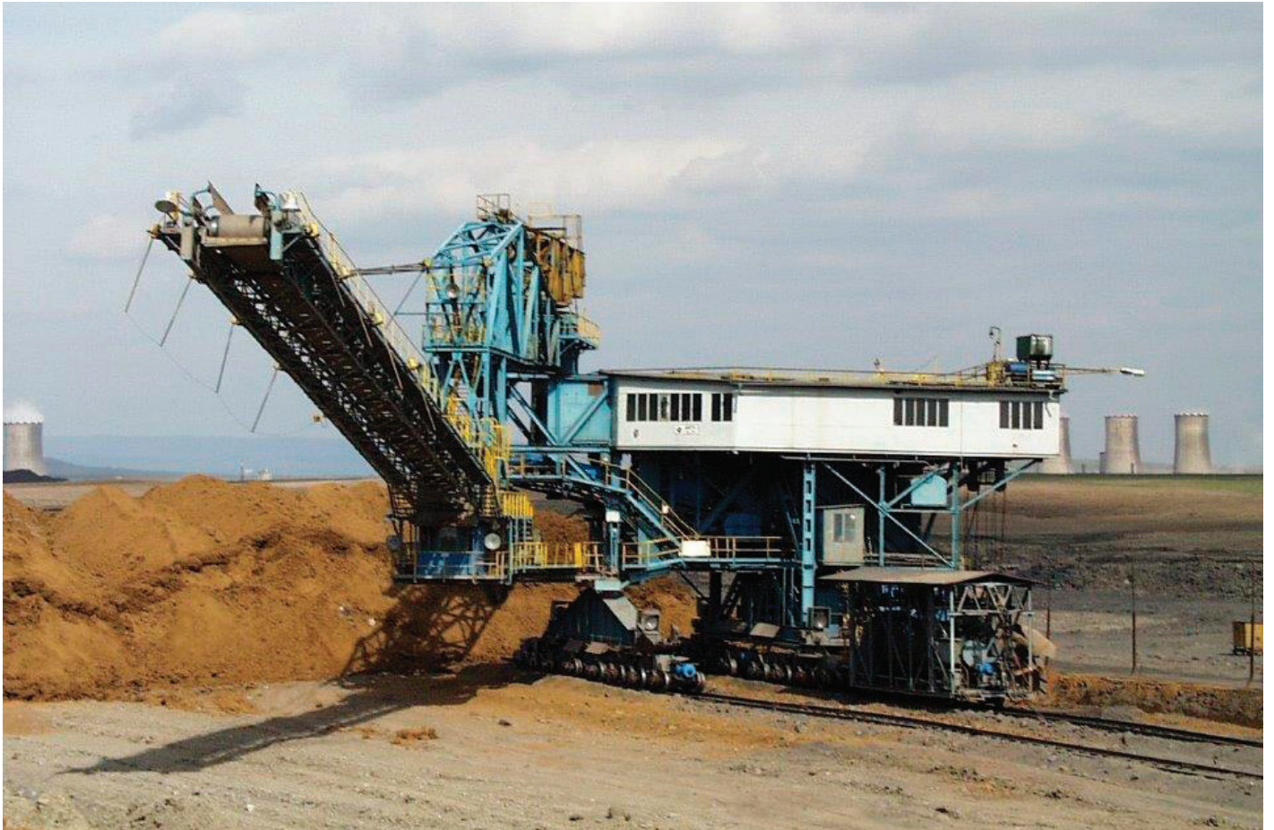
Obr. 3: Kolejový jednovozový zakladač Z 2000/78.
