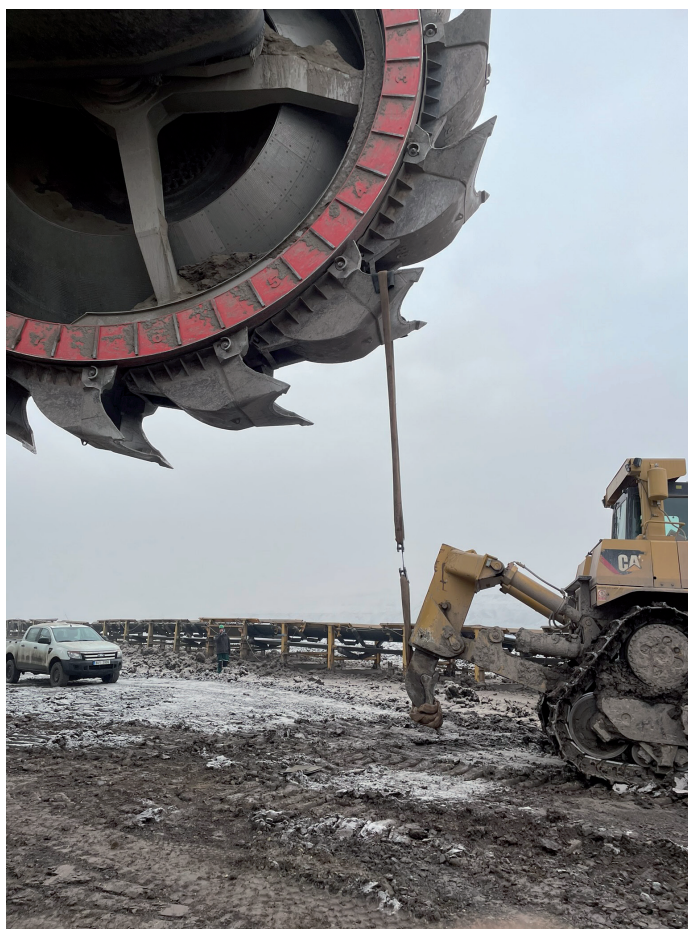
Obr. 3: „Trhací zkouška“ na stroji KK 1600/K112.
