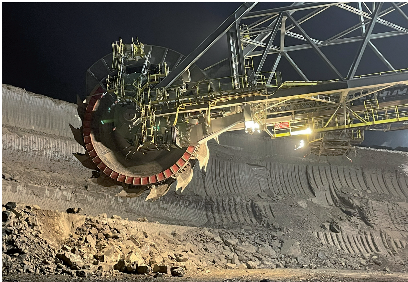
Obr. 9: Situace zájmového horninového bloku při průběhu výkonové zkoušky.
