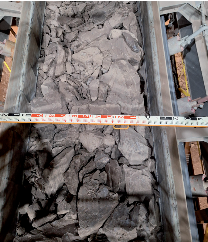
Obr. 7: Kusovitost materiálu při těžbě 1. lávky.
