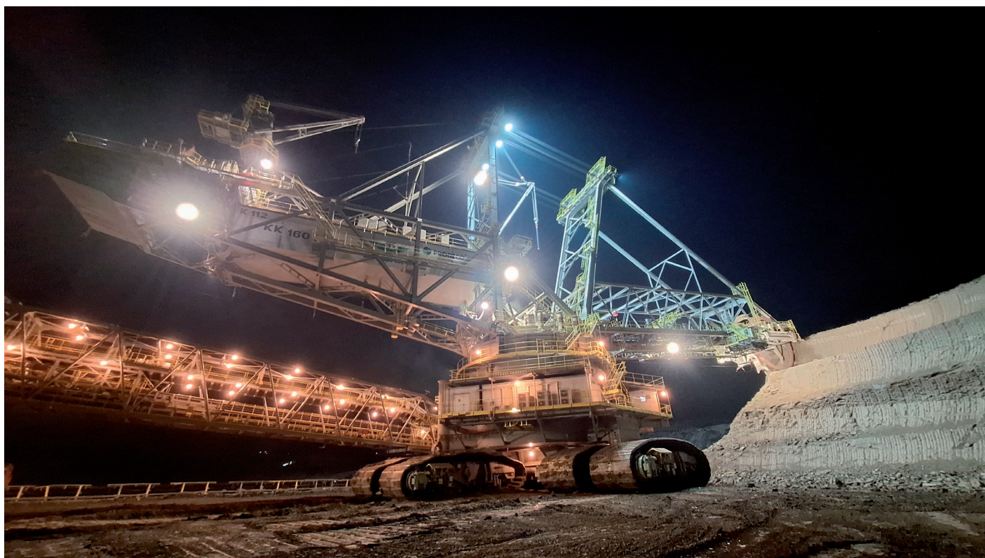
Obr. 1: Celkový pohled na rypadlo KK 1600/K112.
