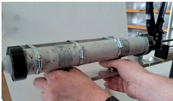
Obr. 17: Poloautomatické zařízení pro 3D suspenzní tisk. (Foto: Z. Černý, AV ČR).
