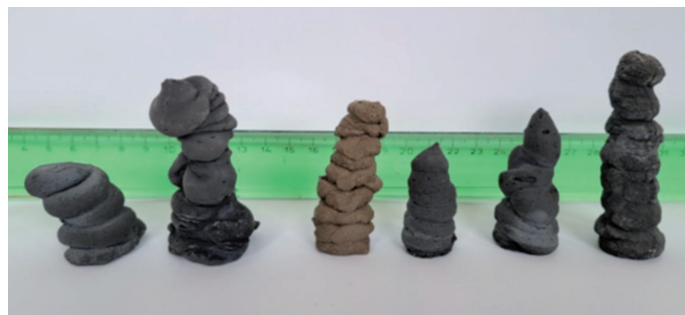
Obr. 16: Vrstvení suspenzí do sloupců v jednom cyklu tisku pro další vývoj systému. (Foto: Z. Černý, AV ČR).
