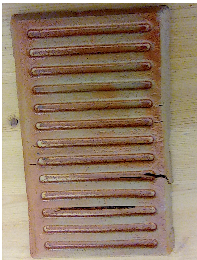
Obr. 13: Zkouška vibrolisovaného vzorku náročného tvaru. (Foto: J. Novotný).
