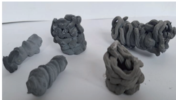
Obr. 15: Zborcené green body nebo technologicky nevhodné suspenze. (Foto: Z. Černý, AV ČR).
