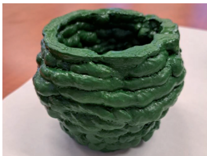
Obr. 19: Povrchová úprava 3D výtisků smaltem při výpalu. (Foto: Z. Černý, AV ČR).
