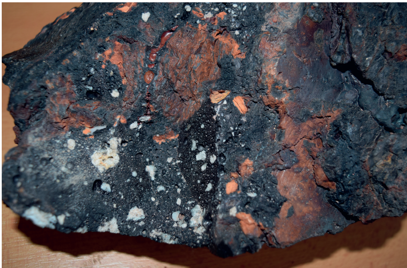
Obr. 1: Brekcie se sekaninitem, bublinatými peckami sanidinu a zlomky vypáleného jílu.
