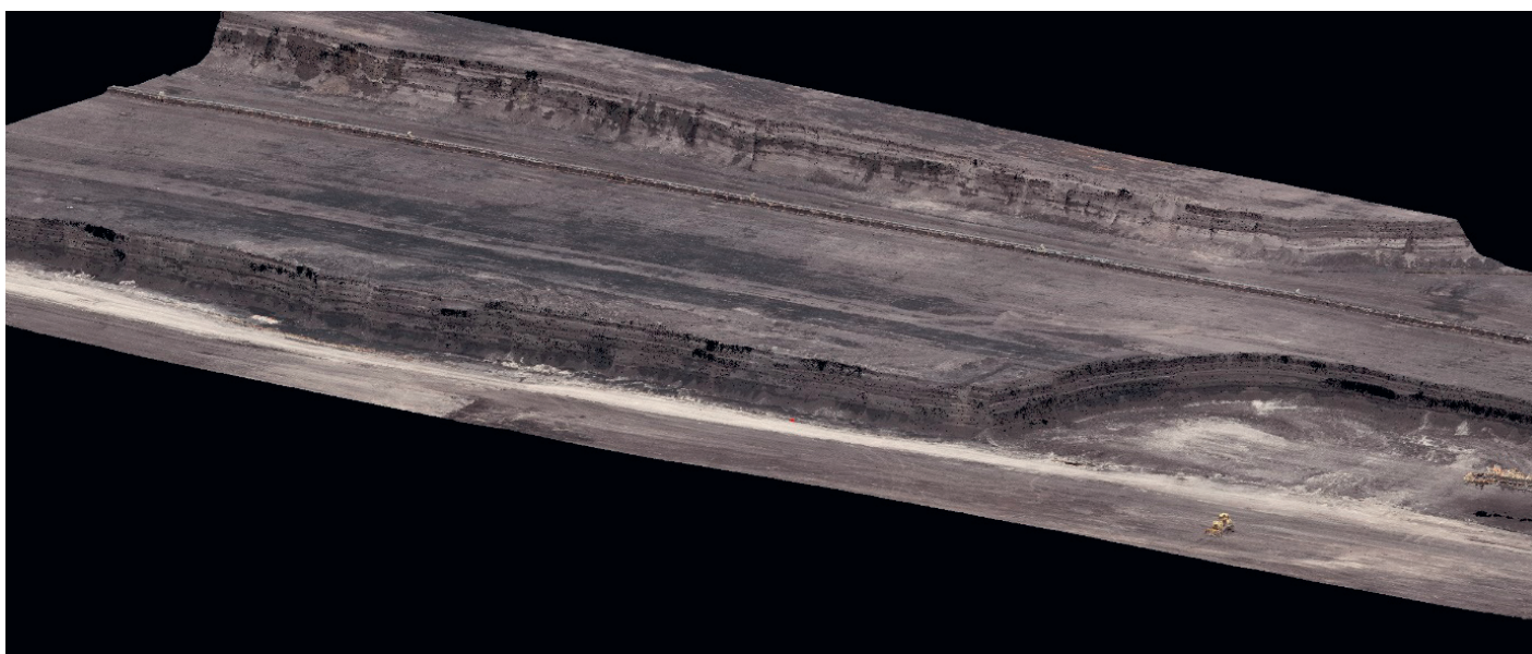
Obr. 10: Výřez bodového mračna získaného metodou „DRON-MRAČNO“ z 3. 7. 2024 v sw Carlson.
