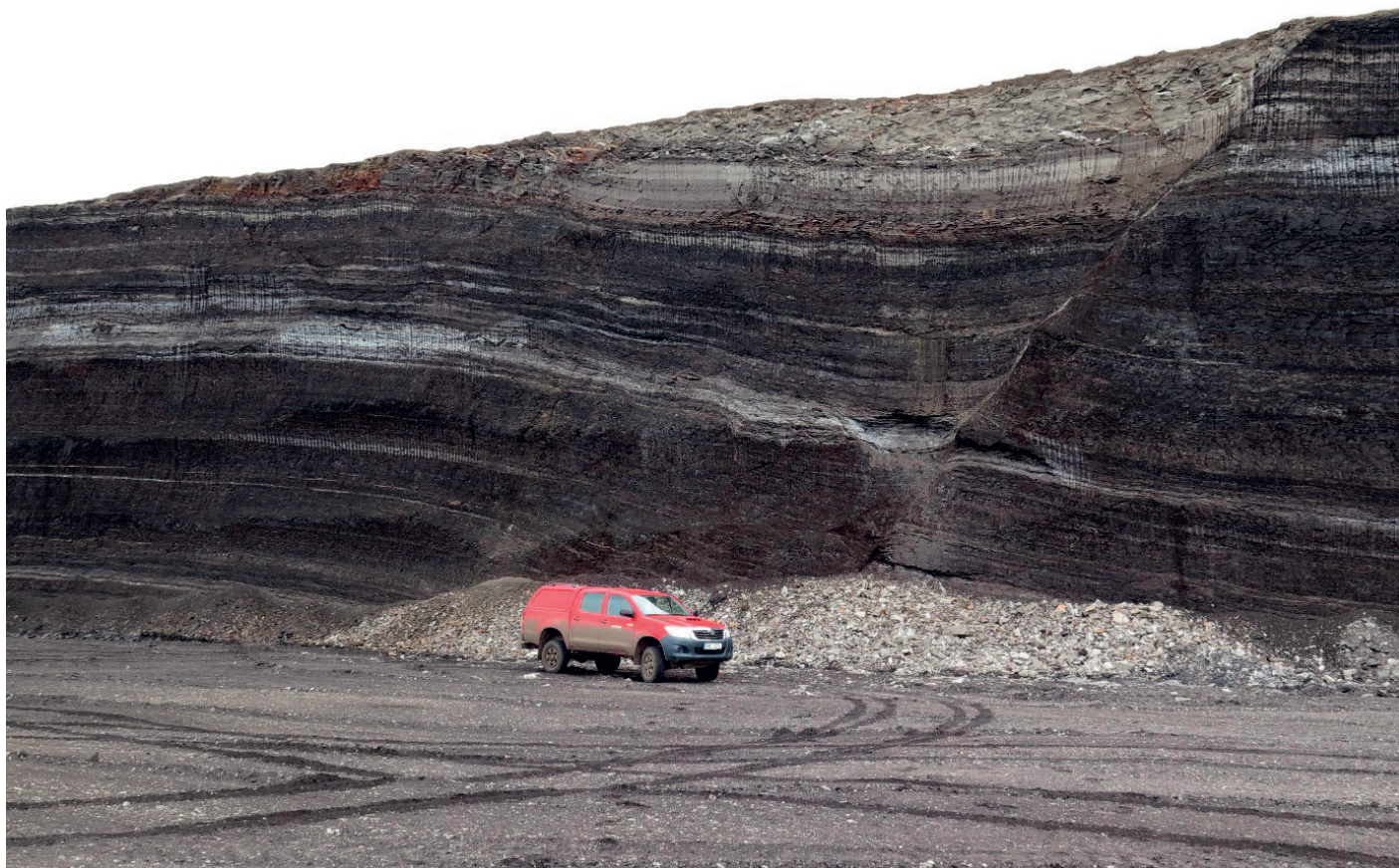
Obr. 3: Těžební řez na dolech Nástup Tušimice. Na tomto příkladu by geolog zakreslil výrazné světlé jílovité proplástky v uhlenné sloji a zejména tektonickou poruchu (zlom) v pravé části snímku. V takto dokonalém stavu řezu by byla použitelná i metoda UAV.
