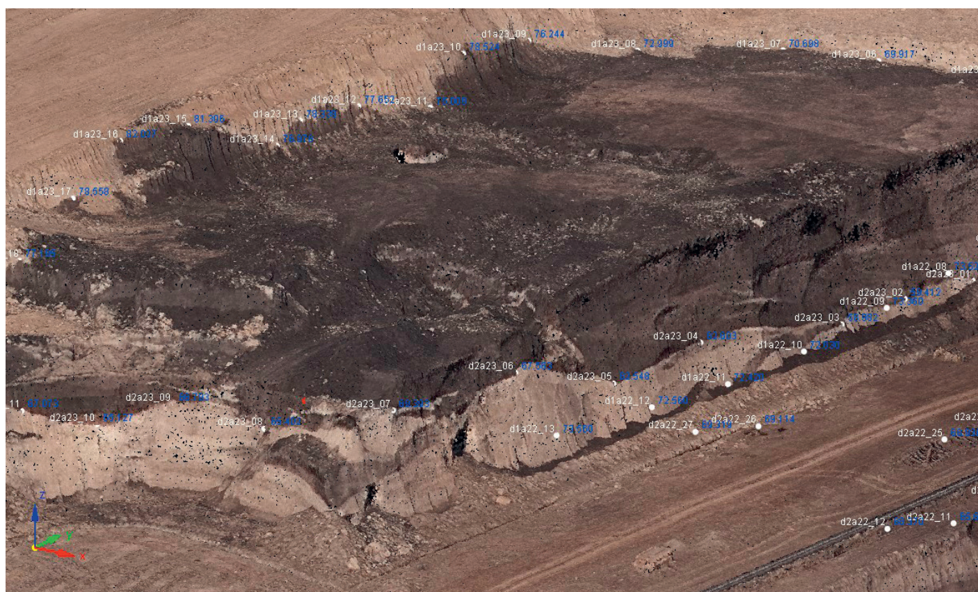
Obr. 4: Příklad úspěšného použití UAV pro geologickou dokumentaci zdeformované svrchní části uhlenné sloje na lomu Bílina. Geologická rozhraní jsou zde jasně vidět.
